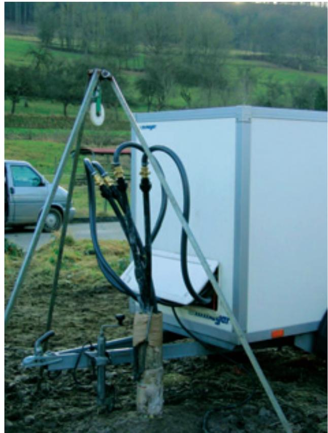
Abb. 4 Aufbau eines Thermal Response Tests
